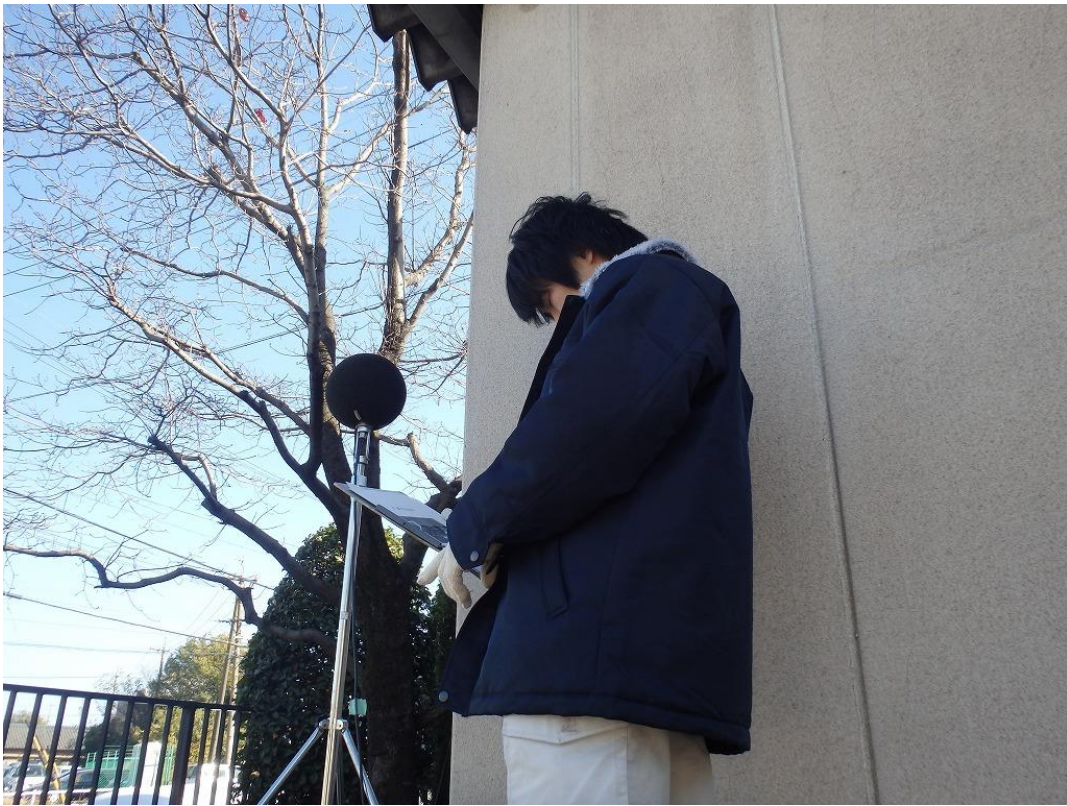
自動車騒音調査：市民体育館
