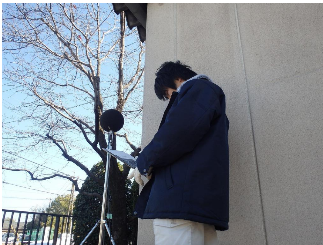
自動車騒音調査：市民体育館
