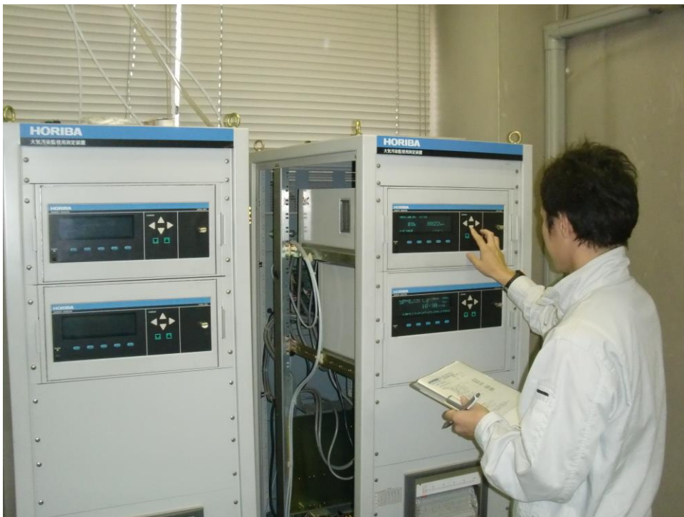
大気汚染自動測定器による常時監視：公害防止センター
