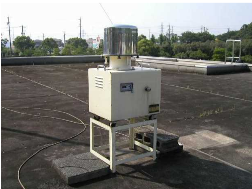
<ローボリューム・エアーサンプラー（市役所公害防止センター）>
