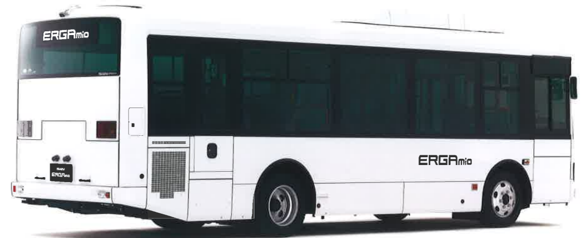
都市型(中乗) ホールベース:J(4,400mm) LR290J4型 カタログ用特別仕様車
