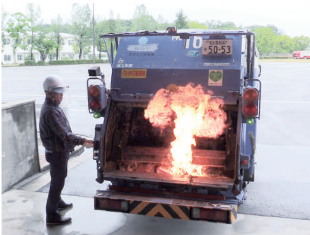
リチウムイオン電池が回収時につぶされて発火 (提供元：独立行政法人製品評価技術基盤機構 nite )
