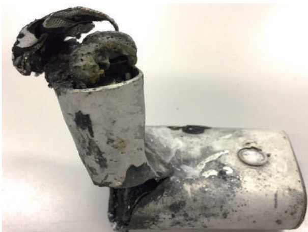
発火原因となった加熱式たばこ (リチウムイオン電池内蔵) (提供元：公益財団法人日本容器包装リサイクル協会)
