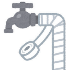
▲むき出しの配管に防寒材を巻く
