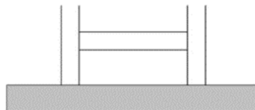
基礎がない例
